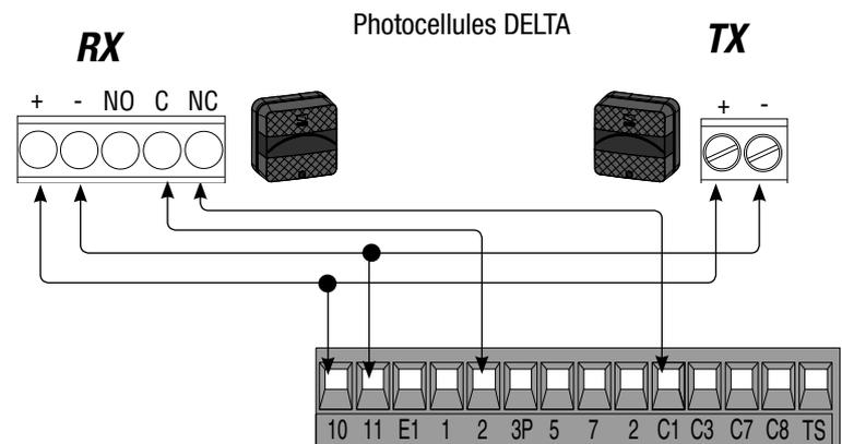
**Contact (N.C.) de «réouverture pendant la fermeture»**
