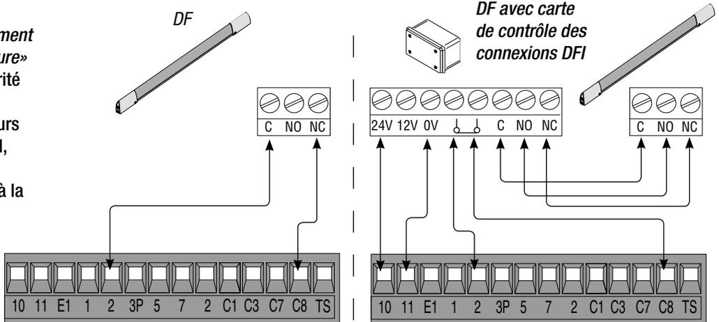
**6.4 Connexion électrique pour le fonctionnement du test de contrôle de sécurité des photocellules**
