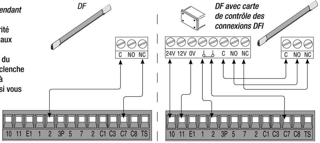
**Contact (N.C.) de «ré-enclenchement de la fermeture pendant l'ouverture»**
