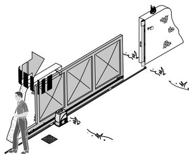
**⚠ (1) Attention :** après 3 détections d'obstacles consécutives, le portail s'arrête en ouverture et la fermeture automatique est éliminée ; pour reprendre le mouvement il faut appuyer sur le bouton de commande ou utiliser l'émetteur.
