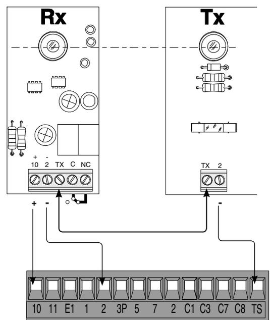
A chaque commande d'ouverture ou de fermeture, la carte contrôle le fonctionnement des photocellules. Une anomalie éventuelle détectée sur les photocellules est signalée par le clignotement de la Led (PROG) sur la carte électronique et elle annule toute commande de l'émetteur radio ou du bouton.
